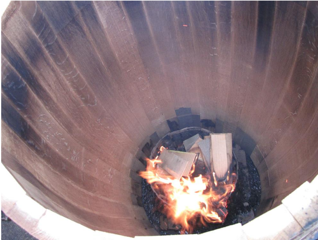
Foto 4: Üblich beim Fassholzausbau ist das sogenannte „Toasten“ des Holzes, bei dem die Innenseiten des Fasses mit Feuer geröstet („getoastet“) werden. Diese Röstaromen werden dann zusammen mit dem Tannin des Eichenholzes an den Wein während der Reifung abgegeben. Foto: Andreas Hösch
