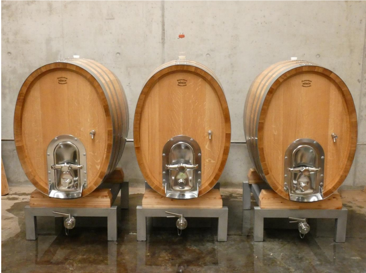
Foto 5: 3 Stück-Fässer (1/2) auf Edelstahlager mit Edelstahl-Verschlussstüren mit Firmenlogo oben. Foto: Andreas Hösch
